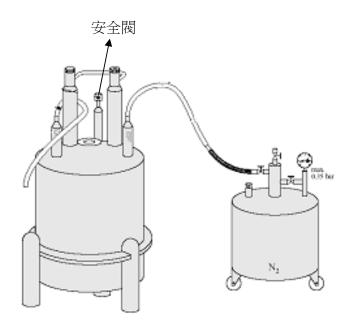
6. 連接完後,慢慢旋開液氮筒上液氮出口調節閥,即可開始灌液氮,如下圖一,充填中勿碰觸 silicon 軟管以免管子斷裂,直等到看見液態氮(水樣)從磁鐵另一液氮出口噴出,表液氮已充滿
